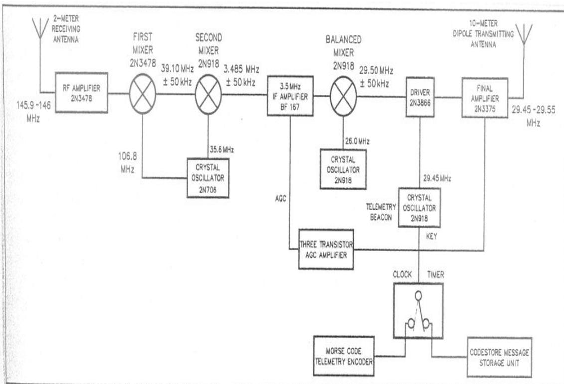
Figura 1: Diagrama de bloques de un transpondedor lineal
